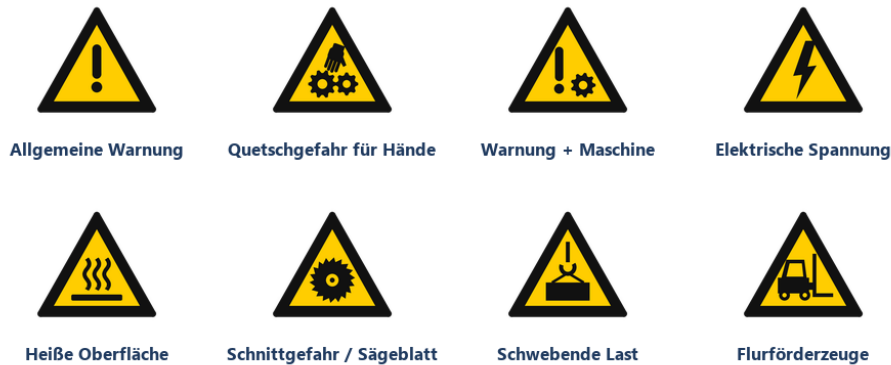
Abbildung 9. Die 8 Sicherheitszeichen. Das Zeichen wird auf den Bericht gedruckt.
